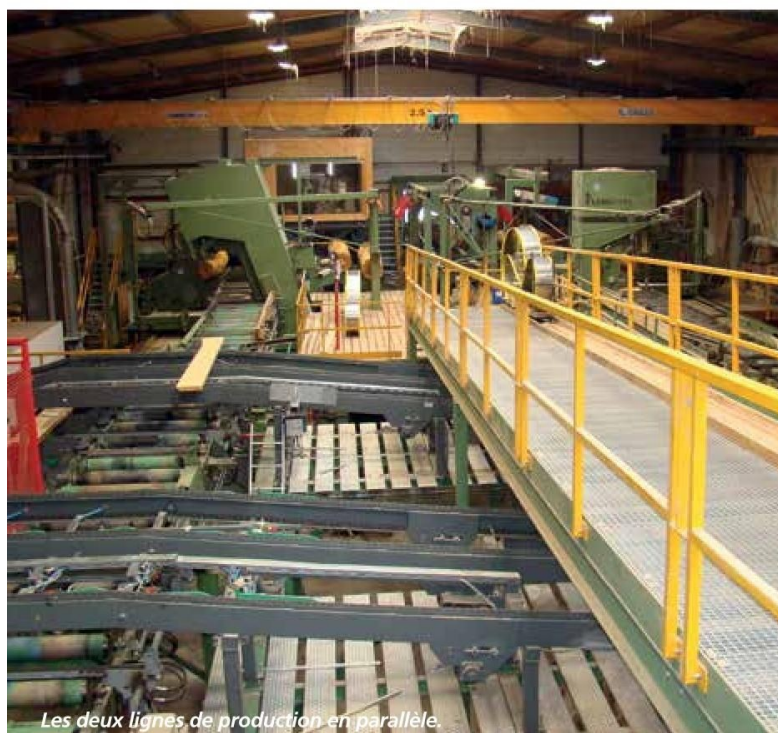
La seconde chaîne d'amenage des billes de hêtre approvisionnant la scie à grumes Primultini
